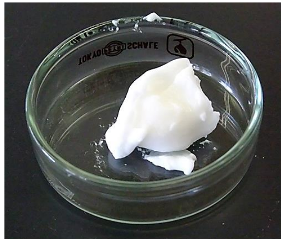
低カロリー油脂(大豆油中に寒天マイクロゲル( \phi=0.7 )が分散している)
