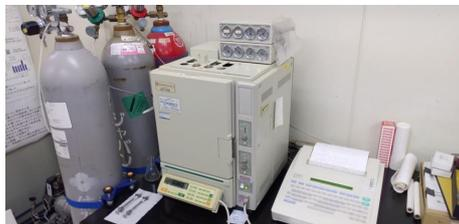
ガスクロ（CO<sub>2</sub>とCH<sub>4</sub>を同時測定）
