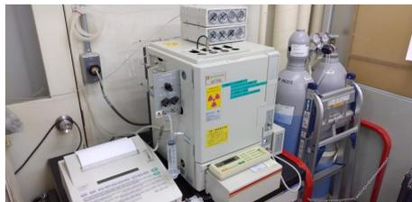
ガスクロ（N<sub>2</sub>O測定）
