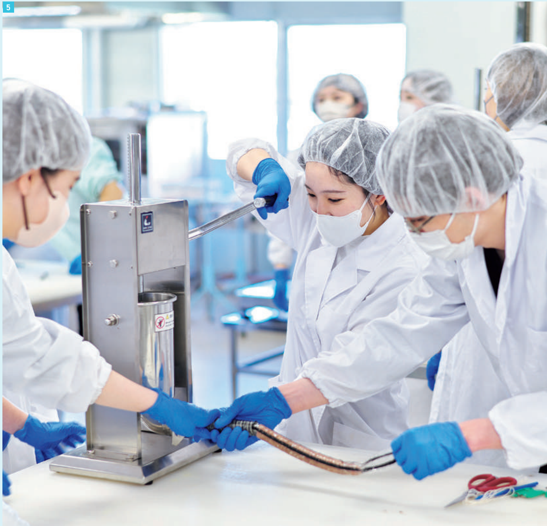
3 塩せきした肉をひき肉にします 4 調合した香辛料とひき肉を混ぜ合わせます 5 ケーシングに充填する作業をします 6 充填されたソーセージはその後燻煙、ポイルします
