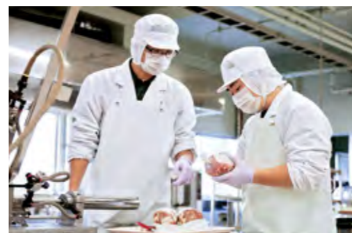
けっさつ 充填・結集後のエア抜き作業
