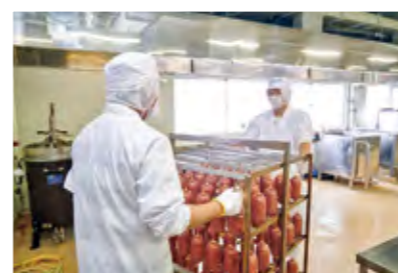
くん煙後のソーセージをボイル槽まで運搬
