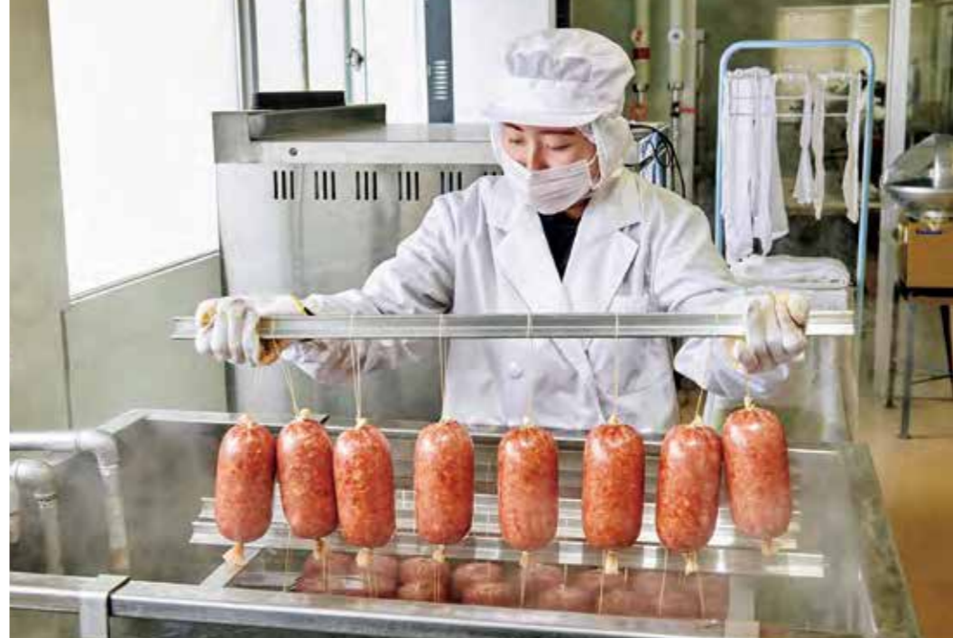
くん煙後のソーセージを加熱。加熱の目的は、肉の結着凝固、肉色の固定及び殺菌です。また授業では、食肉製品中の亜硝酸根残存量についてジアゾ化法を用いて測定しています。
