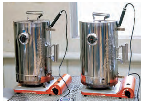
くん煙する木材を変えたりブレンドした試作品を作成し、品質特性に関する試験を実施
