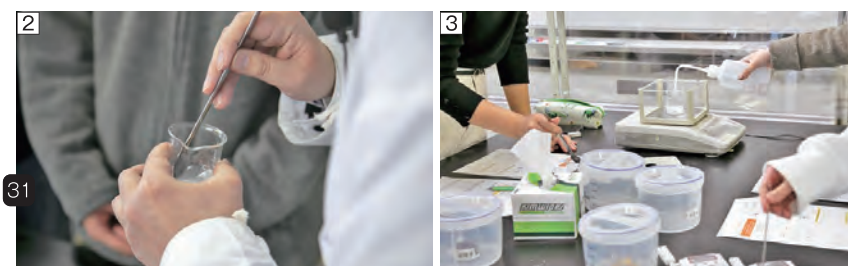
① 水分活性の実験。食品中に自由に動き回れる水分（自由水）がどのくらい存在するか調べ、食品の保存性や冷凍時の影響を学ぶ／② 砂糖や塩を添加したときの自由水を調査している様子／③ 添加物と水の重量を測り濃度を決めて測定。食品製造のレシピには濃度が大事
