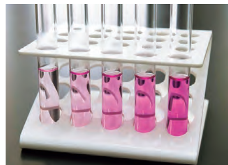
食肉製品中の亜硝酸根残存量を測定
