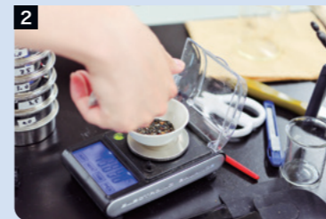
1 地層の剥ぎ取り標本の作成 2 篩分け法による津波堆積物の粒度分析 3 地層観察に基づく津波堆積物の特徴の抽出と共有
